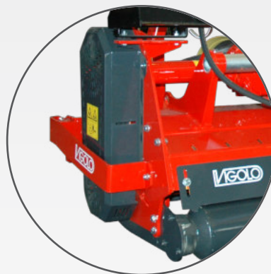
Parapianta lato carter Trees guard belts side Pflanzenstoßfänger Riemen-seite Protection arbres côté carter
